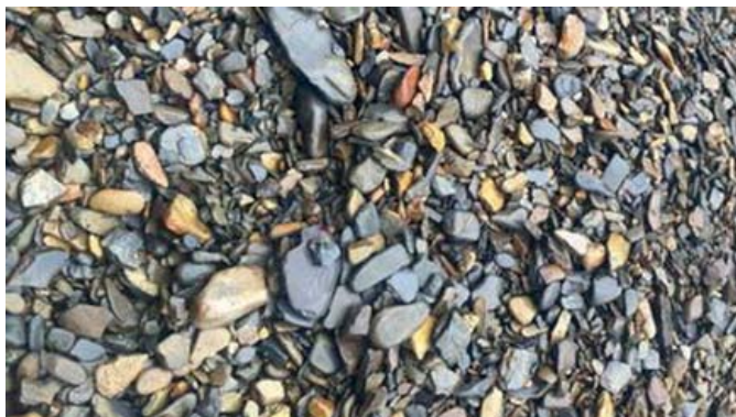
Рис. 6. Вид гали после скруббера и вибрационного грохота (отработка песков с высоким содержанием глины)
