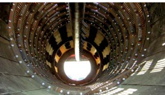
Рис. 4. Внутренний вид барабана скруббер-бутары другого производителя
