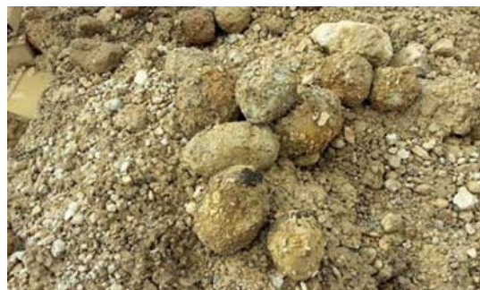
Рис. 5. Галька из скруббер-бутары (отработка песков с высоким содержанием глины)
