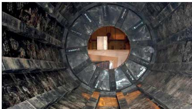
Рис. 1. Внутренний вид барабана высокоэффективного скруббера «Sepro Mineral Systems»
